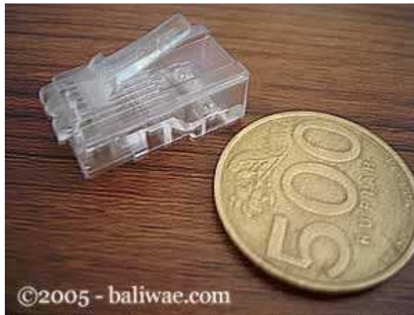
Foto RJ - 45 yang masih baru, belum di gencet pake tang
